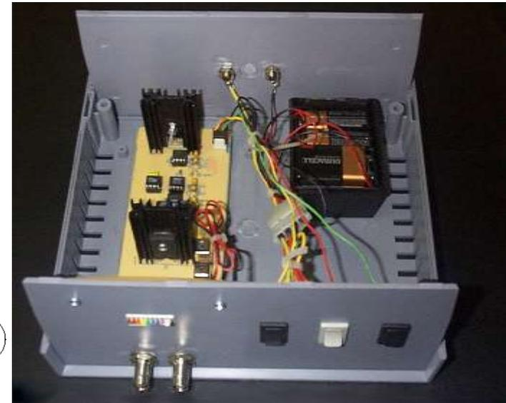
**Instrumento testado:** Anemômetro a fio quente. Usado para medição de velocidade em fluidos. (Será visto ao longo do curso)
